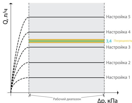
Клапан динамический балансировочный комбинированный R206AM с возможностью установки привода. Предназначен для регулирования и поддержания постоянного расхода при колебаниях давления в контуре.
