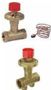
Балансировочный клапан R206C-1 - это регулятор перепада давления для поддержания постоянного перепада давления в любом гидравлическом контуре при любом расходе. Диапазон регулирования номинального перепада давления от 5 до 30 кПа или от 25 до 60 кПа. Клапан поставляется с капиллярной трубкой длиной 1 м, для подсоединения к штуцеру или регулятору расхода (например, R206B) на подающем трубопроводе.
