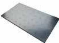
Плоская изоляционная панель преформованная для напольных систем. Изготовлена из вспененного пенополистирола (EPS200) высокой плотности с графитом, с защитным слоем из алюминиевой фольги 0,25 мм. Шаг укладки труб кратный 100 мм. Размер панели: 1200x500 мм.
