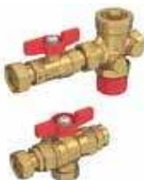
Комплект для фанкойлов компактный. Включает в себя полнопроходной шаровый кран со встроенным фильтром, автоматический балансировочный клапан - регулятор расхода, запорный шаровый кран. Подключение к фанкойлу отводами с накидными гайками.
