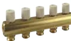
Коллектор распределительный возврата с регулирующими термостатическими клапанами, с отводами с наружной резьбой. Возможна установка электротермической головки (сервопривода) R478, R478M, R473, R473M, на место демонтированных рукояток. Межосевое расстояние: 50 мм.
