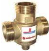
Антиконденсатный термостатический смесительный клапан предназначен для регулирования и поддержания заданной температуры теплоносителя в обратном контуре твердотопливного котла или котла с наддувной горелкой. Использование термостатического смесительного клапана предотвращает образование конденсата в теплообменнике и дымоходе котла. Клапан, таким образом, влияет на эффективность работы котла и защищает его от повреждений.
