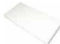
Панель изоляционная преформованная для систем напольного отопления, из экструдированного вспененного полистирола XPS300 или XPS500. Теплопроводность 0,034 Вт/(м·К). Эффективный размер 1250x600 мм.
