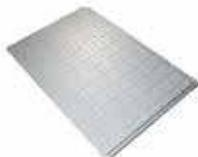
Плоская изоляционная панель преформованная для напольных систем. Изготовлена из вспененного пенополистирола двойной плотности (EPS200+EPS120) с графитом, с защитным слоем из полиэтилена. Шаг укладки труб кратный 50 мм и 100 мм. Размер панели: 1200x800 мм.
