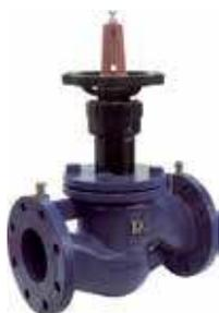
Статический балансировочный клапан с чугунным корпусом, с затвором из нержавеющей стали, фланцевым соединением и штуцерами, размером 1/4", с внутренней резьбой для измерения дифференциального давления. Возможность применения с гликолевыми растворами -10-120 °С, PN16
