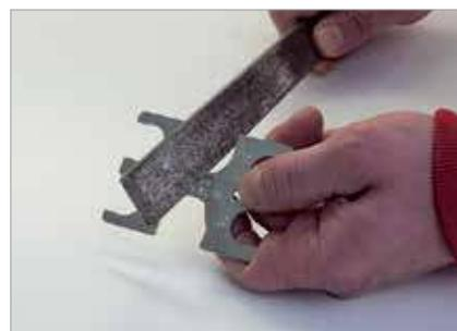
Не модифицируйте измерительный прибор никоим образом. Он должен быть заводского изготовления с погрешностью 0.5 мм.
