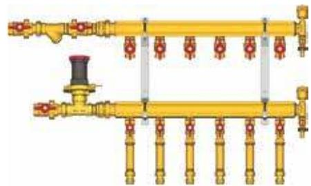
Узел коллекторный отопления этажный, подключение к системе с регулятором перепада давления, подключение к потребителям тип В1: с шаровым краном, отводом с накидной гайкой и проставкой на место монтажа теплосчетчика
