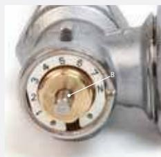
3. При снятии ключа шток (деталь В) останется в требуемом положении преднастройки, определяемом по номеру на кольце клапана. Положения настройки: 1, 2, 3, 4, 5, 6, 7, N = Все открыто. Кроме обозначенных настроечных положений, имеющих паспортные тарированные значения, можно установить и промежуточные положения настроек.
