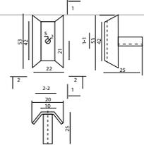
H=22 мм, W=43 мм, Винт М4-30
