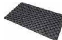
Панель изоляционная преформованная для систем напольного отопления, из пенополистирола EPS150. Шаг укладки 50 мм. Для трубы диам. 15-18 мм. Эффективный размер 1400x800 мм.
