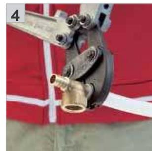
4 Поместите инструмент таким образом, чтобы обжимное кольцо полностью было закрыто захватами инструмента. Держите инструмент под углом 90° к фитингу, и сожмите его полностью.
