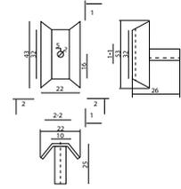
H=22 мм, W= 43мм, Винт М4-30
