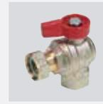
Угловой полнопроходной шаровой кран с внутренней резьбой и накидной гайкой с плоской прокладкой, для гидравлических систем, латунный никелированный с алюминиевой флажковой рукояткой.
